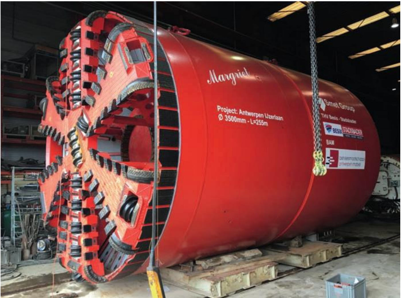
Tête de tunnelier. TBM head
