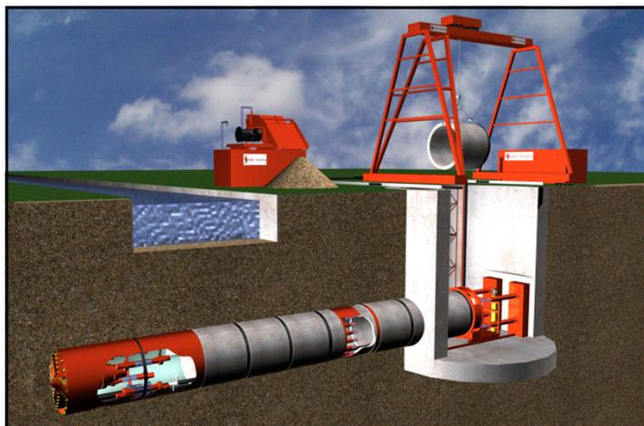
**Le microtunnelage à l'aide d'un système de forage à front fermé, pour les fonçages dans des diamètres non accessibles et accessibles (diamètre interne de 400 mm à 3 200 mm), est la solution idéale pour les croisements souterrains de rivières, de routes, pour les zones naturelles et autres infrastructures.**
