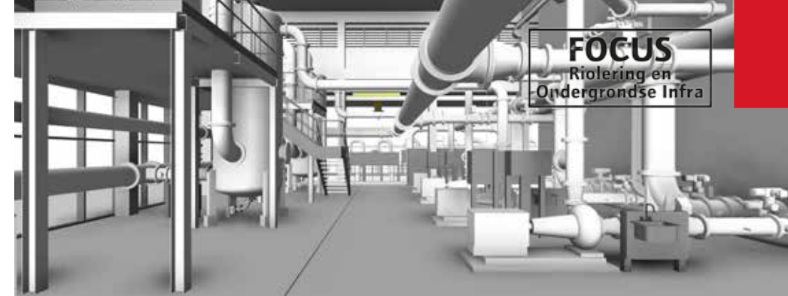
Het beluchtingsgedeelte wordt ondergebracht in een gesloten cel, die eveneens plaats biedt aan twee zandfilters.
