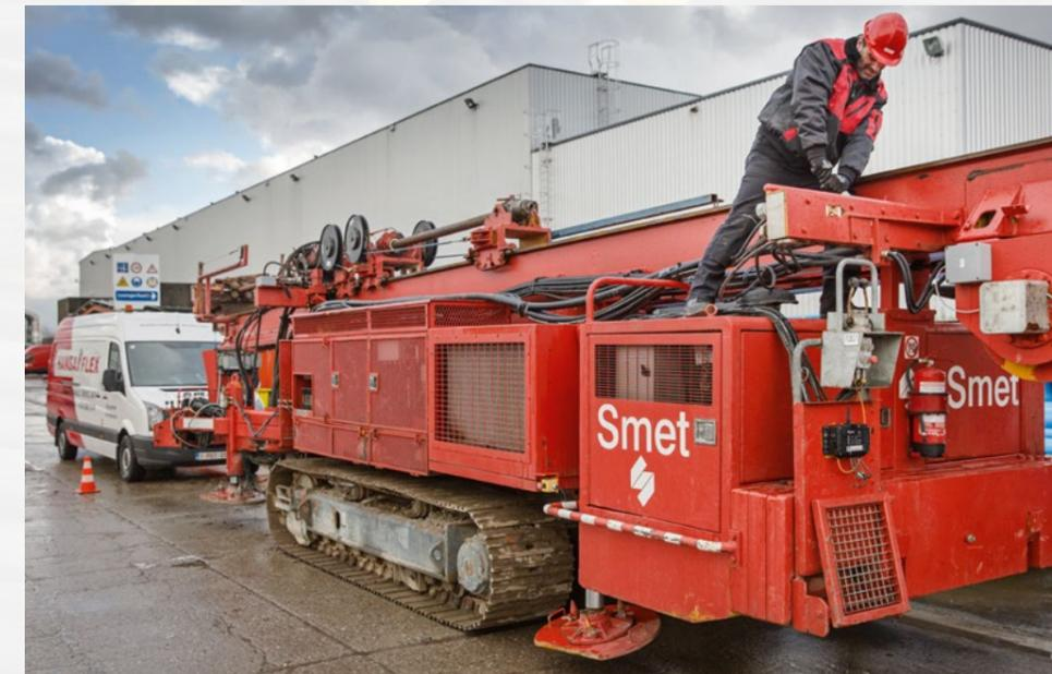
» Die Smet Group setzt vorwiegend HD 700 PRO-Schlauchleitungen mit 4 Spiralen aus Stahldraht ein.
