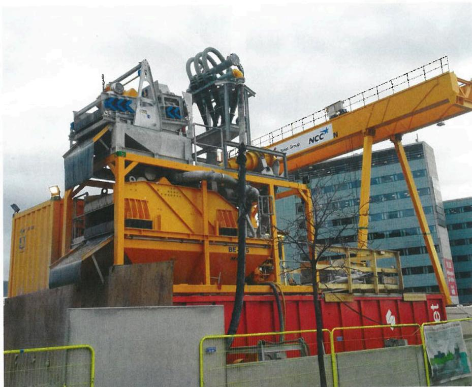
Blick auf die Separationsanlage BE-425-60. Im Hintergrund ist die eingehauste Zentrifuge BD-60 zu erkennen.
