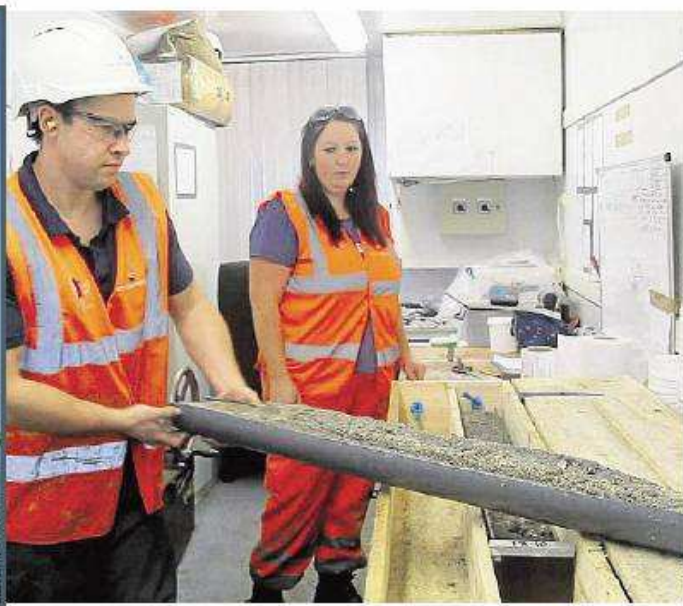
C'est à partir de la barge Goliath que les techniciens réalisent des carottages préparant l'arrivée du champ éolien.
