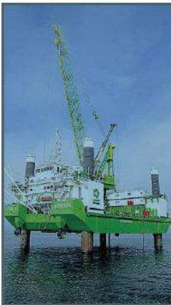
C'est à partir de la barge Goliath que les techniciens réalisent des carottages préparant l'arrivée du champ éolien.
